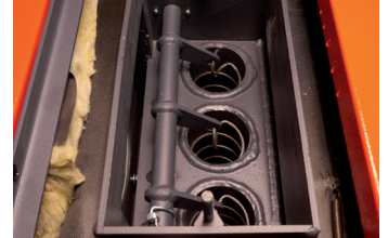
Fig. 6: Tubi scambiatore di calore con turbolatori
