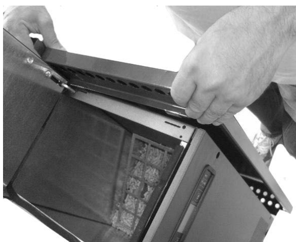
Fig. 29 - Inserimento dei pannelli
