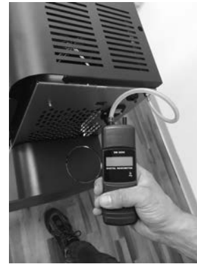
Fig. 48 - Collegamento pressostato digitale
